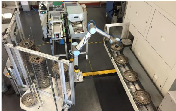
▲ Si les cobots de BW Industrie ne peuvent porter des charges lourdes, ils peuvent réaliser les tâches répétitives indéfiniment et avec une grande précision. — Photo : BW Industrie
